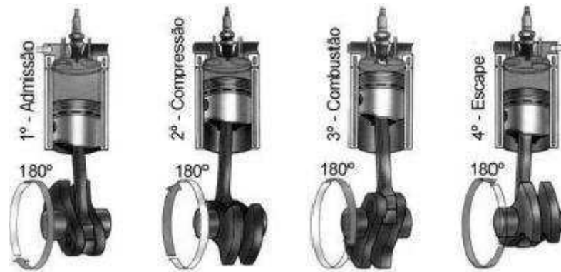
Figura 7-Ciclo de operação do motor diesel.
