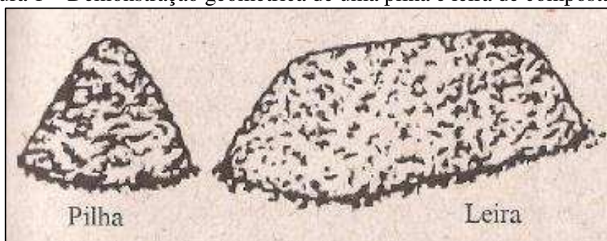
Figura 1 – Demonstração geométrica de uma pilha e leira de compostagem
