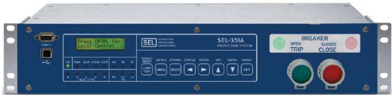
Figura 5.1: do relé com Botões dedicadas para comando seguro de fechamento e abertura do disjuntor.
