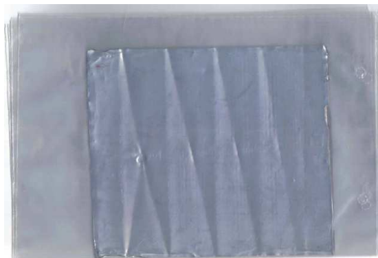
Figura 19 - Placa metálica de alumínio envolta por filmes de PELBD
