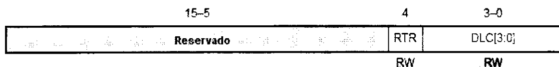
Figura 11.5: Esquemas com as posições dos bits no registrador MSGCTRLn.
