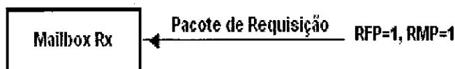
Figura 11.8: Esquema com o processo de recepção de uma requisição remota por um MBOX de recepção.
