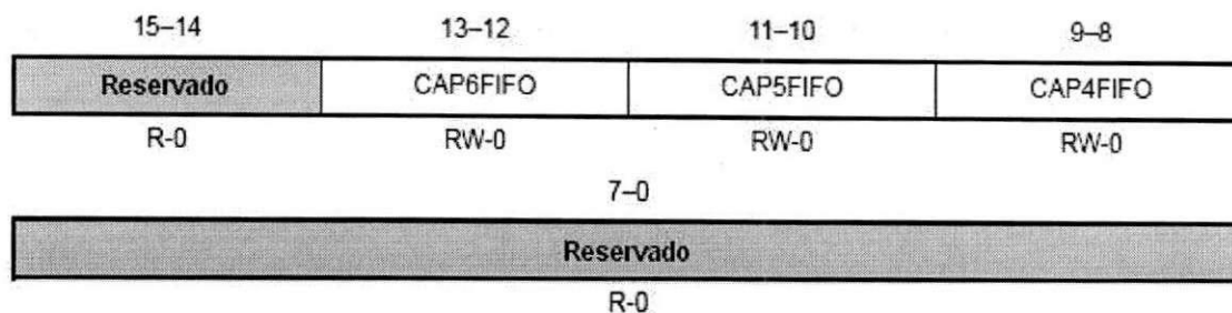
Figura 7.31: Esquema com as posições dos bits no registrador CAPFIFOB.
