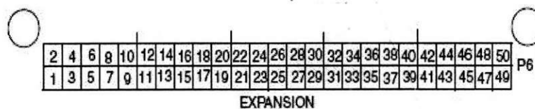
Figura 13.6: Posições dos pinos do conector P6.
