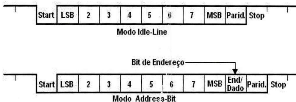
Figura 9.2: Esquema com o formato de dados NRZ.
