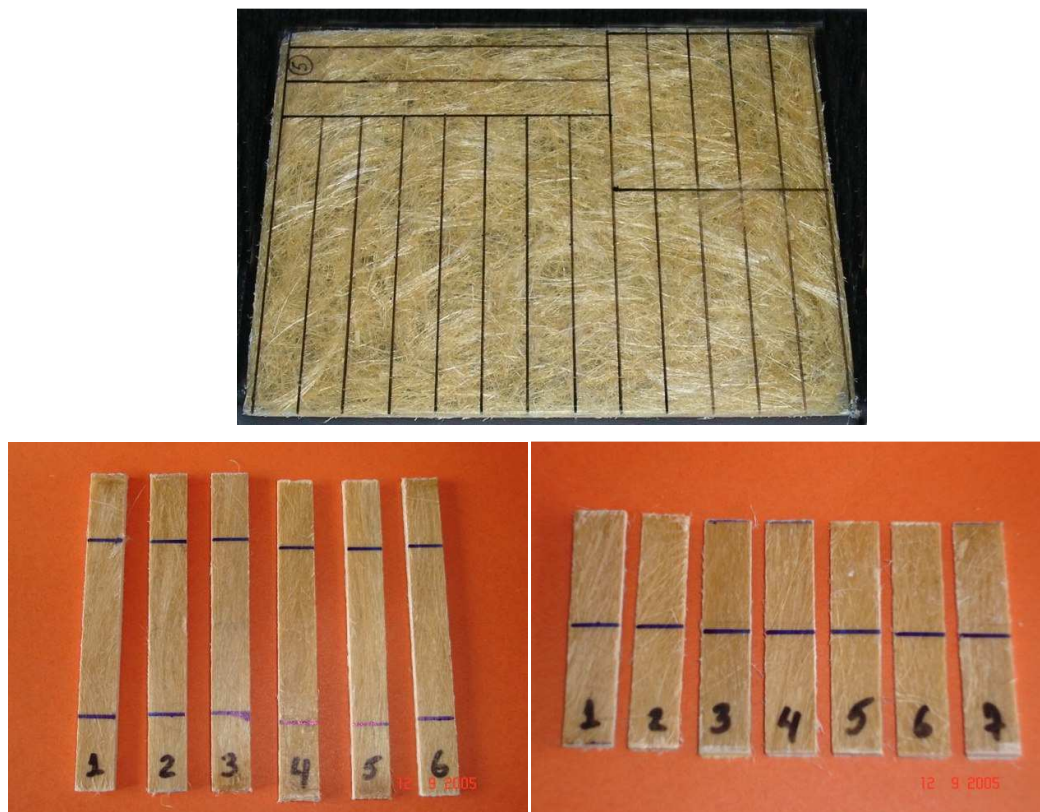
Figura 3.4 – Compósito produzido com fibras de caroá, para ensaios mecânicos.
