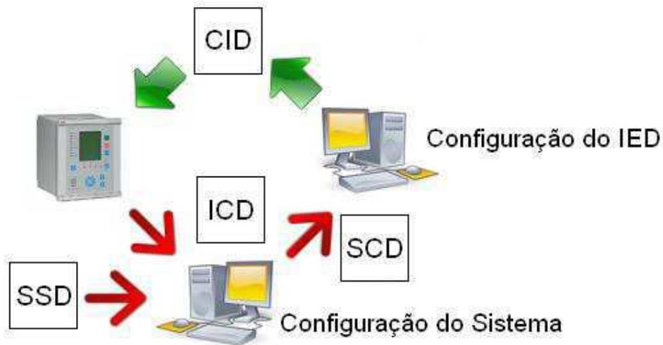
Figura 11. Fluxo de arquivos SCL na configuração de um IED
