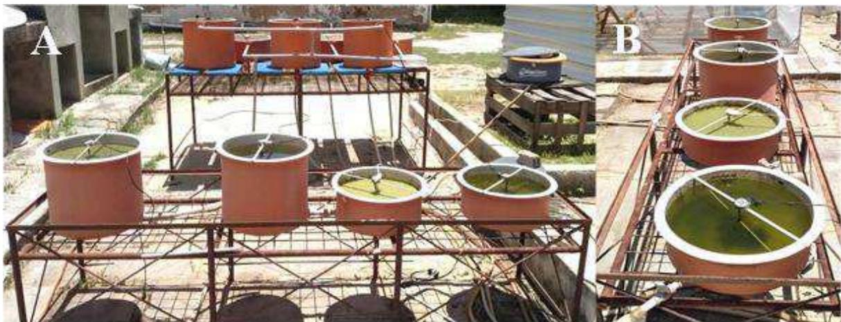
Figura 5 - (A) Detalhe da palheta giratória da mistura da lagoa. (B) LPFC2 de 0,40 metros de profundidade.
