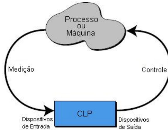
Figura 2.2: Diagrama de aplicação de CLP. (Modificado de: ver [9])
