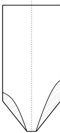
Figura 14 - Silo com descarga incompleta. Fonte: CALIL JÚNIOR & CHEUNG (2007)
