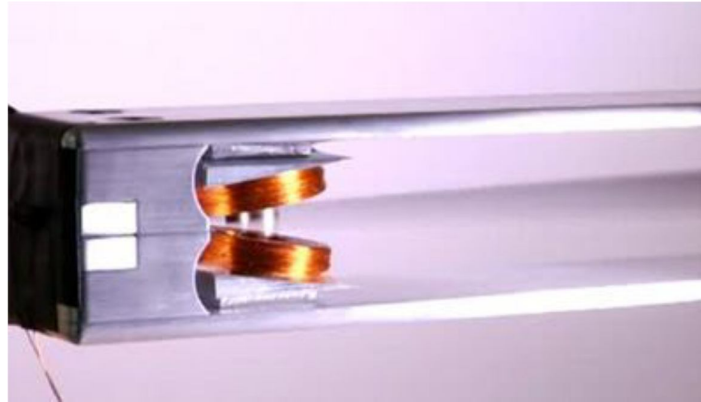
Figura 4.12 - Fenômeno “flutter” no ímã do windbelt.
