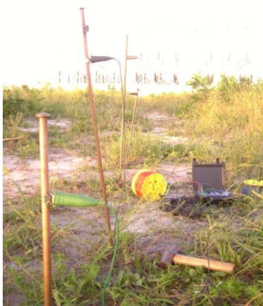
Figura 16. Fotografia da medição de resistividade do solo.
