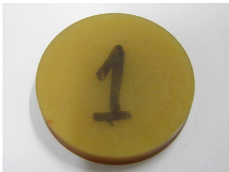
Figura 31 – Fotografia do corpo de prova construído com Fenolite (FR4).
