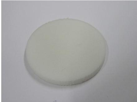
Figura 33 – Fotografia do corpo de prova construído com SLS/Poliamida PA.
