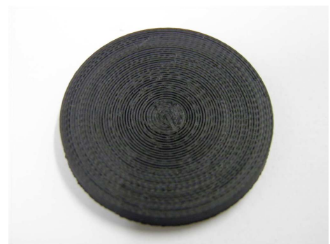
Figura 32 – Fotografia do corpo de prova construído com FDM/ABS.
