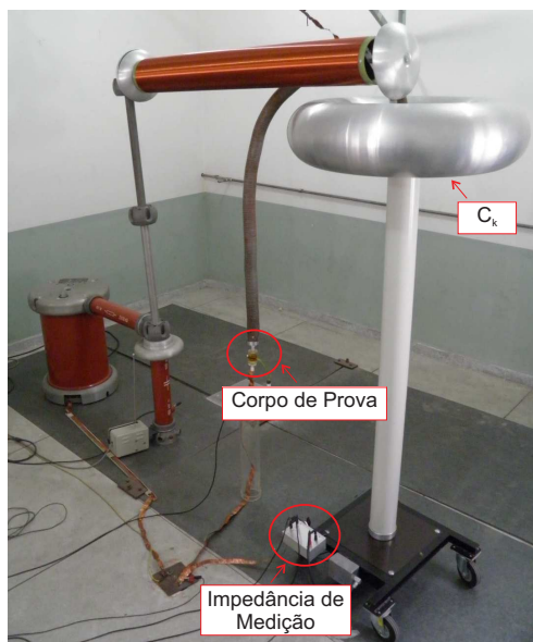
Figura 36 – Fotografia do arranjo de medição de descargas parciais usando um HFCT.
