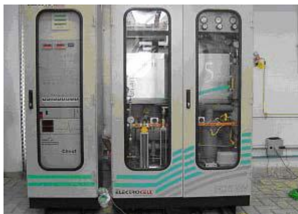
Figura 29- Célula a Combustível de 5 kW para aplicação residencial desenvolvida pela Electrocell Fonte: (NETO, 2007)
