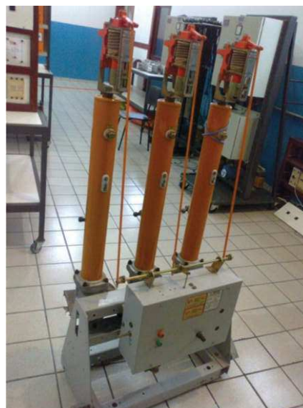
(b) Disjuntor D2.
