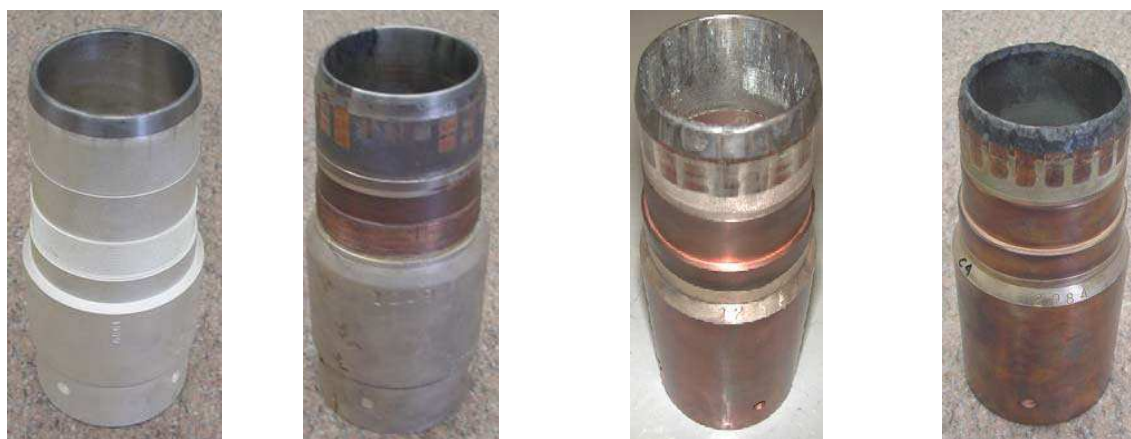
(a) Novo. (b) Degradação baixa. (c) Degradação média. (d) Degradação alta.
