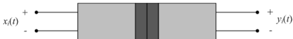
Figura 5.3 - Representação do esquema de ligação do sistema ao par ultrassônico.
