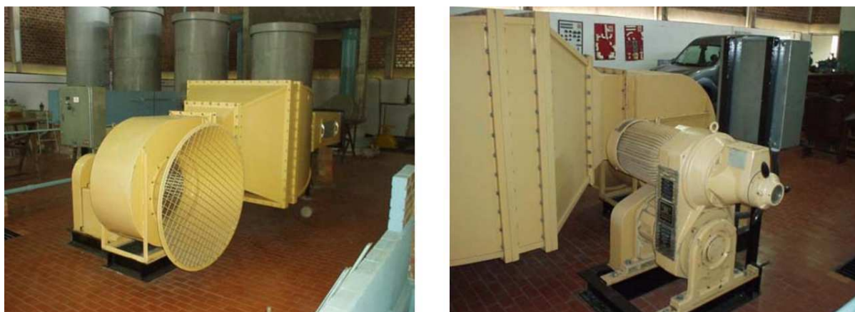
Figura 7.2 - Fotos de túnel de vento subsônico.
