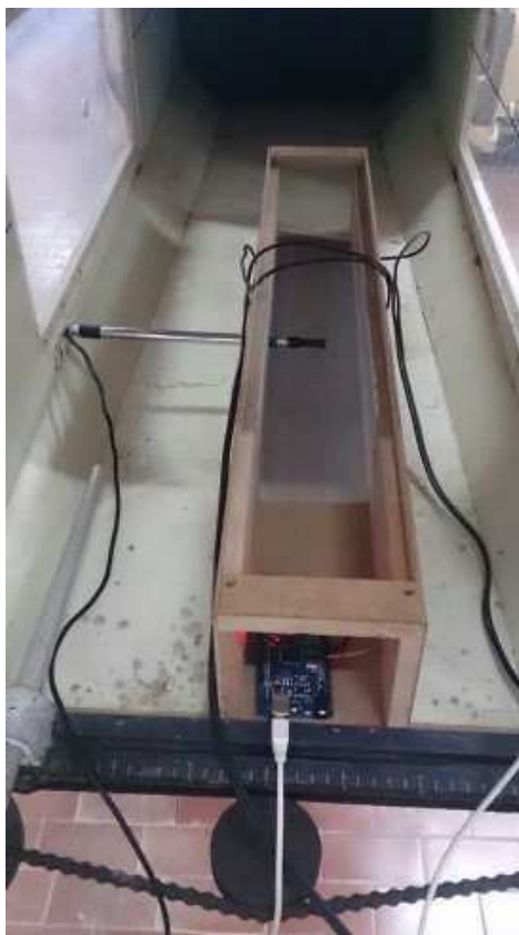
Figura 7.3 - Foto da estrutura em madeira acoplada ao túnel de vento.
