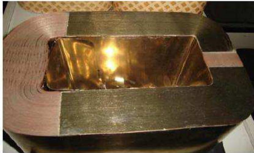
Figura 30 – Núcleo de liga amorfa de um transformador produzido industrialmente (LUCIANO *et al*, 2009).
