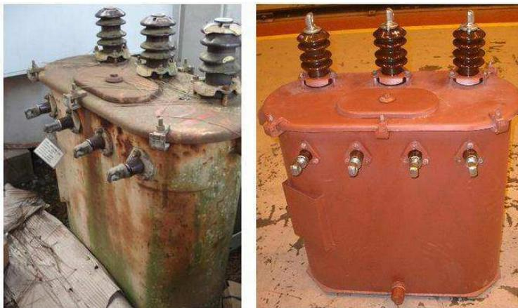
Figura 28 – Repotenciação de um transformador de distribuição imerso em óleo, trifásico com potência nominal de 15 kVA em 60 Hz, fabricado em 1973 (CARVALHO, 2009).
