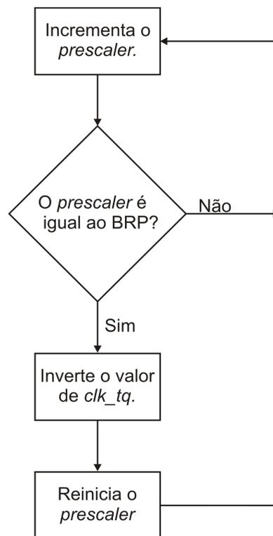
**Figura 5.1** – Diagrama de blocos do módulo Divisor de Clock.
