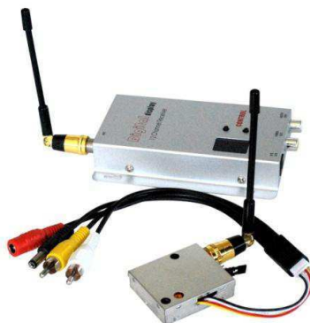
Figura 7. Transmissor e Receptor de Áudio e Vídeo com Alcance de até 500 m.
