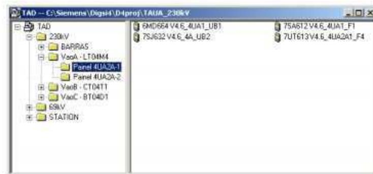
**Figura 8.** Exemplo de hierarquia de projeto de subestação no DIGSI.
