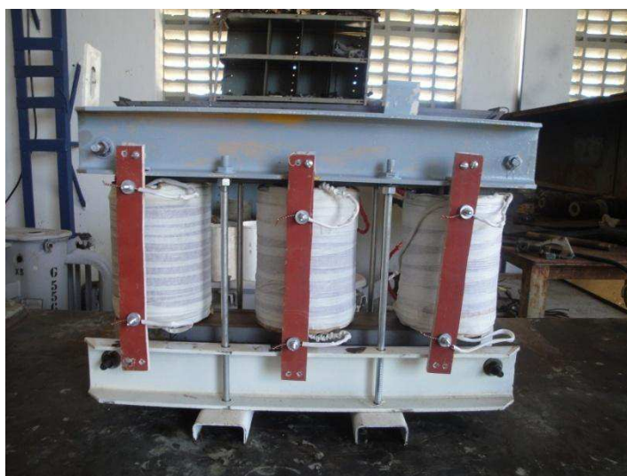
Figura 15 - Lado primário pronto
