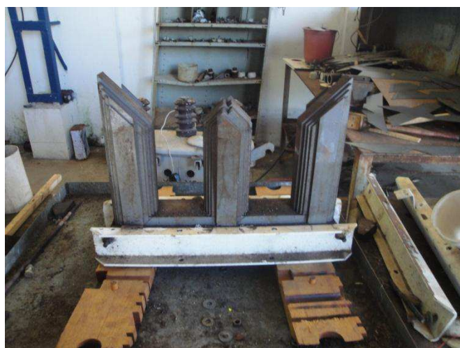
Figura 9 - Núcleo do transformador escolhido
