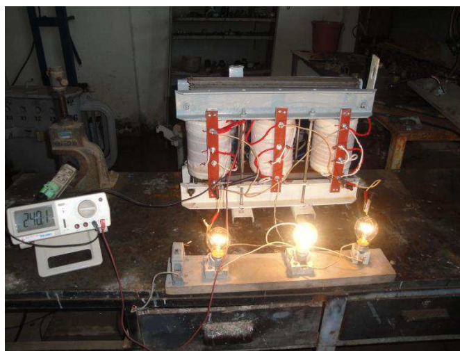
Figura 18 - Ligação Triângulo – Triângulo alimentando carga em Triângulo
