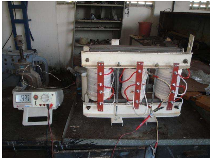
Figura 17 - Teste a vazio aplicando individualmente 220 V a cada fase
