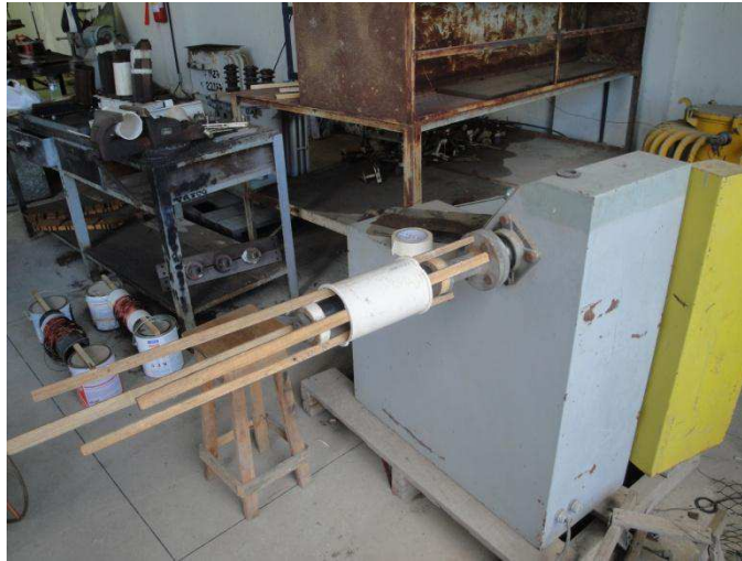
Figura 10 - Arranjo montado para enrolar as bobinas
