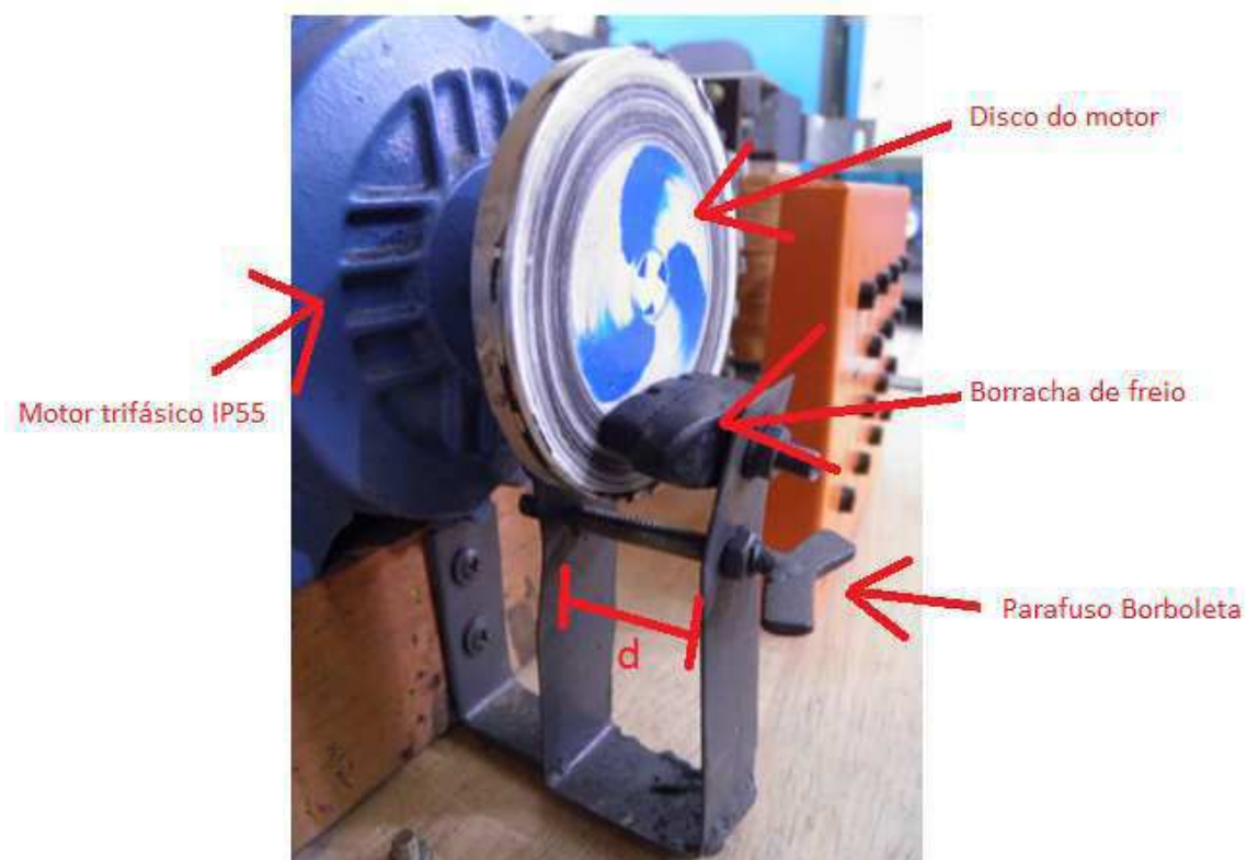
Figura 20 - Simulador de carga acoplada ao eixo do motor.
