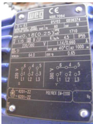
Figura 22 - Placa do Motor Trifásico IP55.
