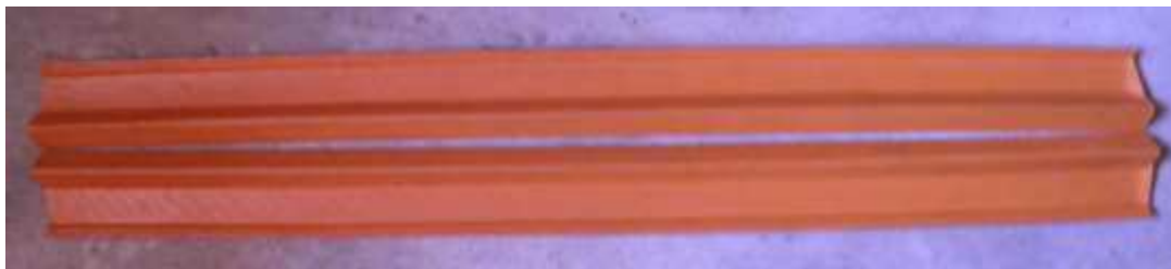
Figura 17 - Cobertura de condutor cortada ao meio.
