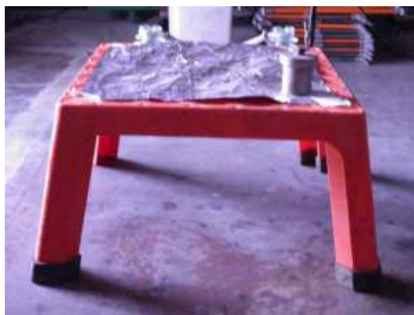
Figura 7 - Ensaio em banquetta isolante.
