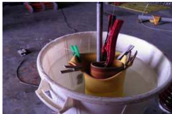
Figura 4 - Esquema e montagem invertida para ensaio de mangas isolantes.
