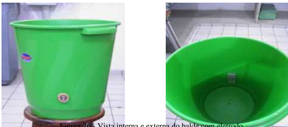
Figura 26 - Vista interna e externa do balde com eletrodo.
