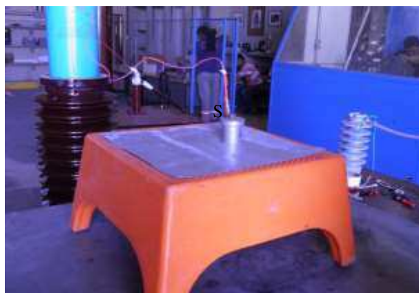
Figura 16 - Ensaio em banqueteta com novo eletrodo.
