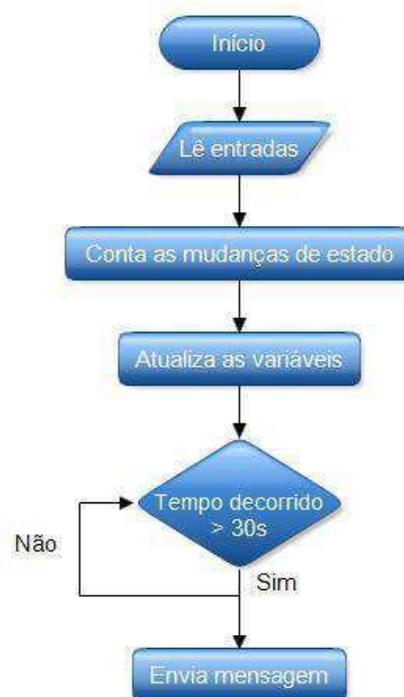
Figura 25. Fluxograma da lógica de funcionamento do programa.
