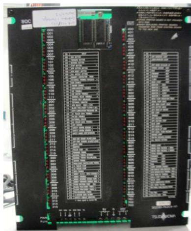
Figura 18. Placa SQC: supervisor dos sinais de sensoriamento e outros status de funcionamento.
