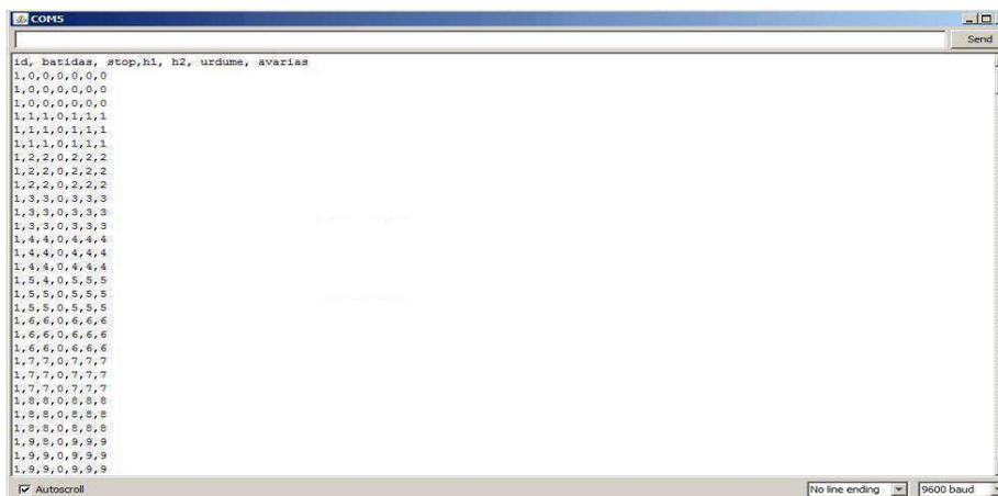
Figura 26. Simulação da contagem de pulsos nas entradas digitais.
