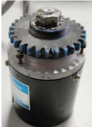
Figura 17. Encoder utilizado para mensurar a rotação do pente de batidas
