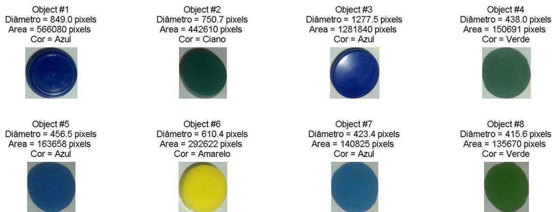
FIGURA 10 – DETECÇÃO DE CORES DOS OBJETOS IDENTIFICADOS DA FIGURA 10
