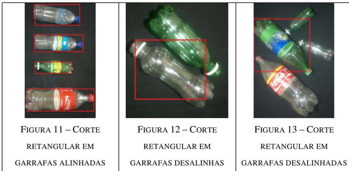
No entanto quando as garrafas assumem direções aleatórias como exibido nas Figuras 12 e 13, o corte retangular interfere diretamente na análise de cores da imagem, uma vez que é possível existirem partes de outras garrafas de cores diferentes na mesma imagem.
