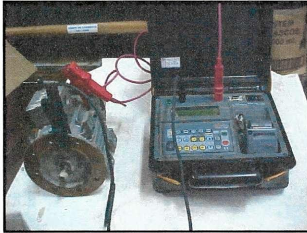
FIGURA 47 – Detalhe frontal do equipamento megômetro – Destinado para a medição do nível de isolação.
