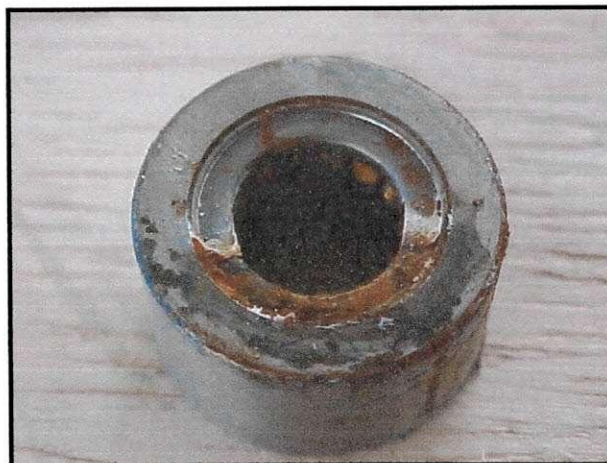
FIGURA 35 – Rolamento do contato móvel oxidado.
