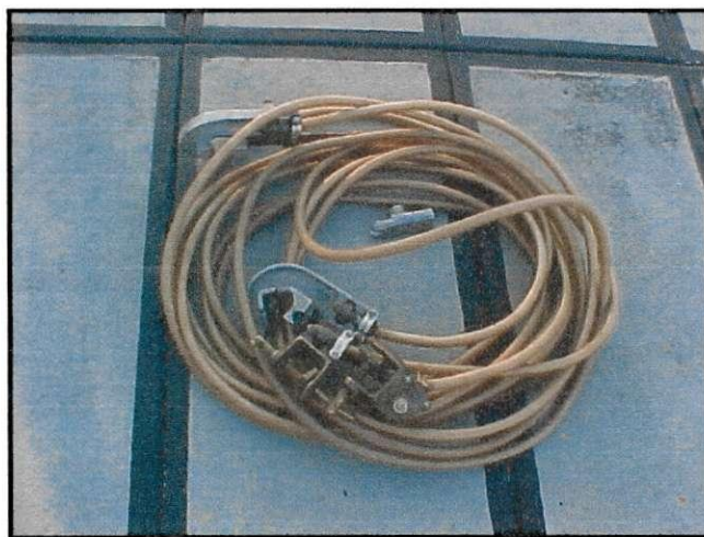
FIGURA 11 – Cabo para aterramento.
