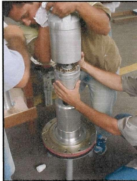
FIGURA 44 – Finalização da montagem do contato fixo.
