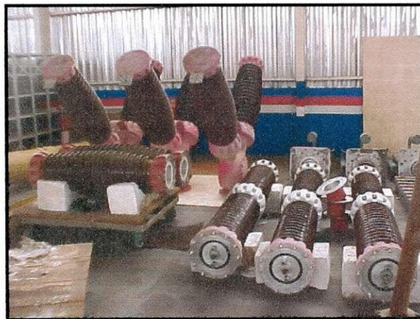
FIGURA 25 - Início da desmontagem das partes constituintes do disjuntor a SF 6 .
