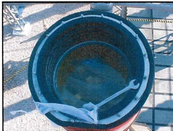
FIGURA 17 – Qualidade do óleo contido no reservatório.
