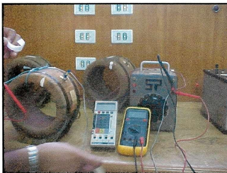
FIGURA 02 – Montagem para a medição da RDT
