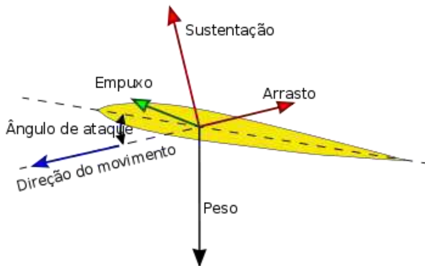
Figura 14 – Forças Atuantes em um Aerofólio (WIKIPÉDIA, 2013)
