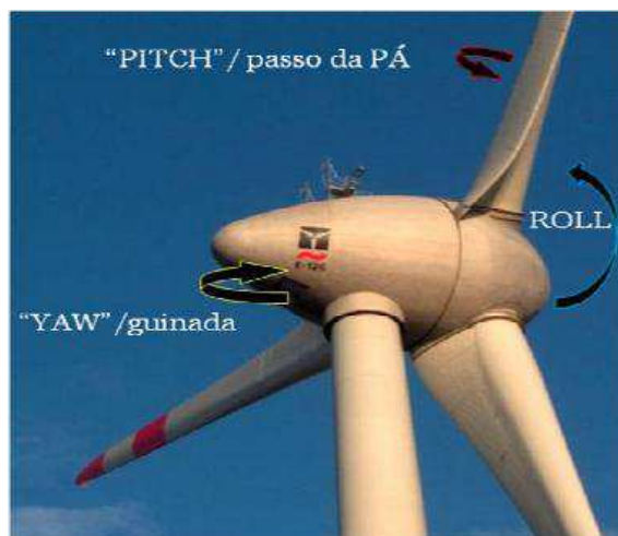
Figura 13 – Movimentos de uma Turbina Eólica (Araújo, A. M. UFPE, 2011)
