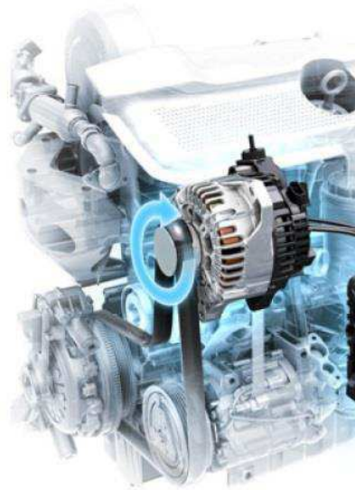
Figura 22:Localização do alternador na configuração do motor: Fonte: KREMER (2011)
