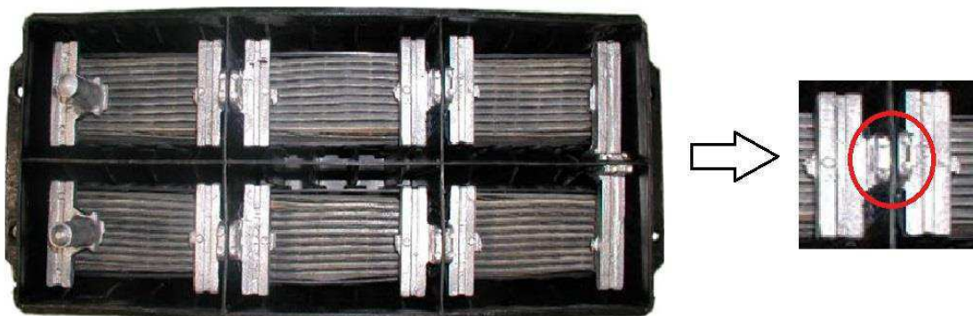
Figura 15: Solda Intercell. Fonte: PEREIRA (2006)
