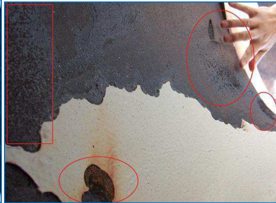
FIGURA 11 - FENÔMENO DA CAVITAÇÃO FONTE: ENGENHARIACIVIL.COM, 2012.
