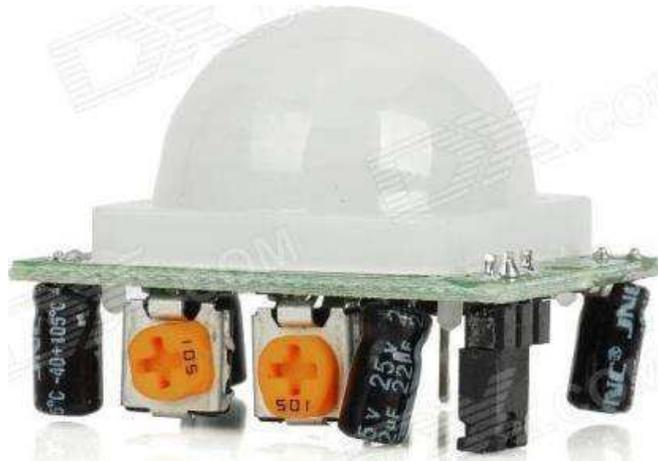
**Figura 16** – Sensor de presença infravermelho.
