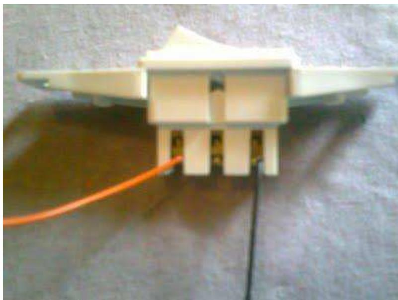
**Figura 19** – Interruptor paralelo ou *three-way*, necessário para fazer a instalação elétrica com acionamento em dois pontos distintos de forma simultânea.
