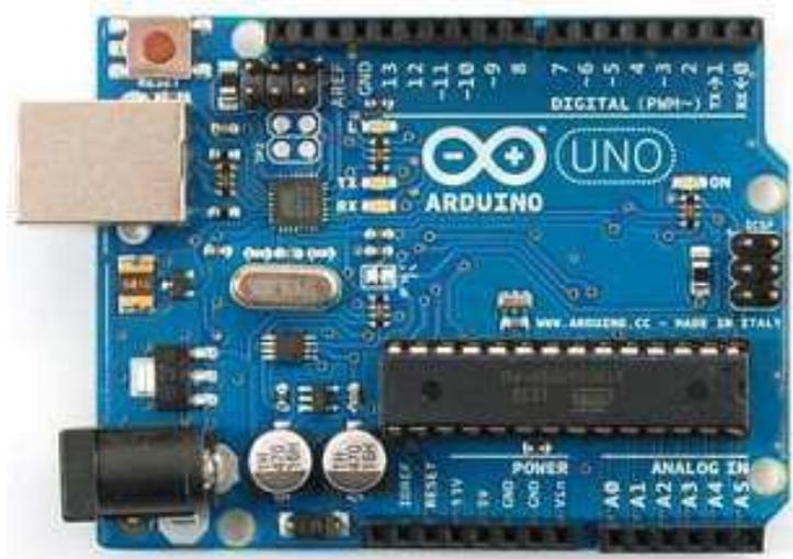
**Figura 3** - Placa de desenvolvimento Arduino, com microcontrolador ATMEL de 8 bits.
