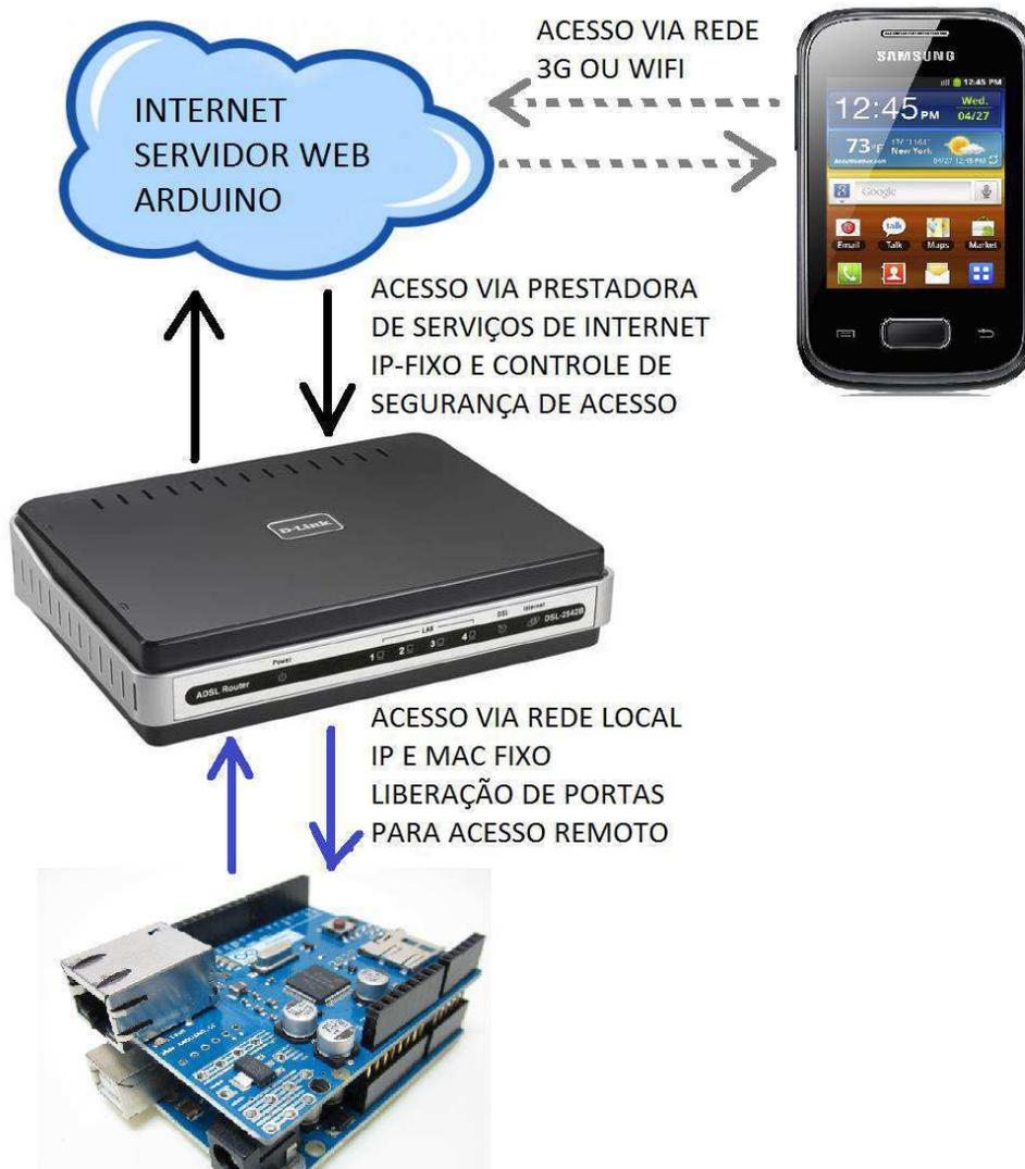
**Figura 10** – Topologia de acesso ao servidor do Arduino de forma remota via internet.
