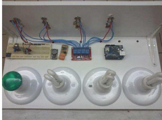
**Figura 25**– Construção do protótipo e versão final já com as conexões elétricas efetuadas conjuntamente com o sistema de automação residencial.
