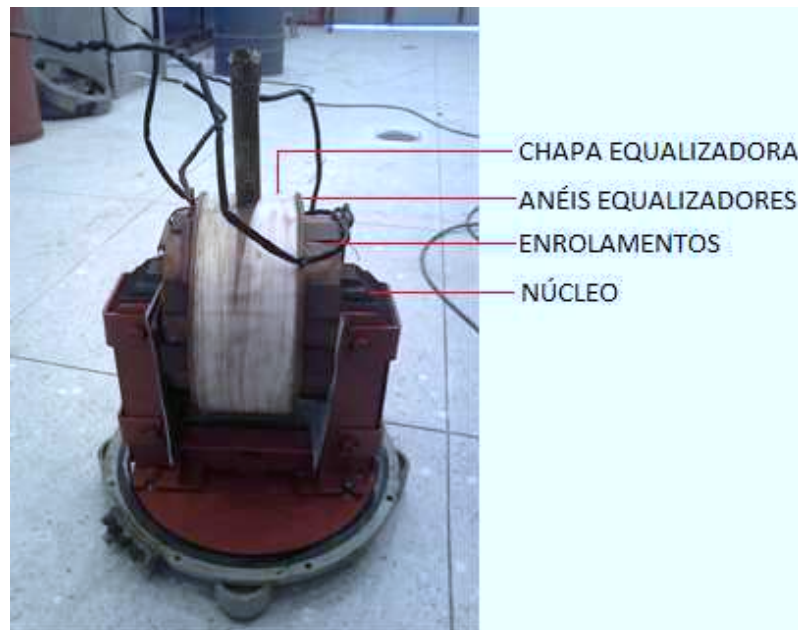
Figura 19. Anéis e chapa equalizadora envolvendo o enrolamento de alta tensão.
