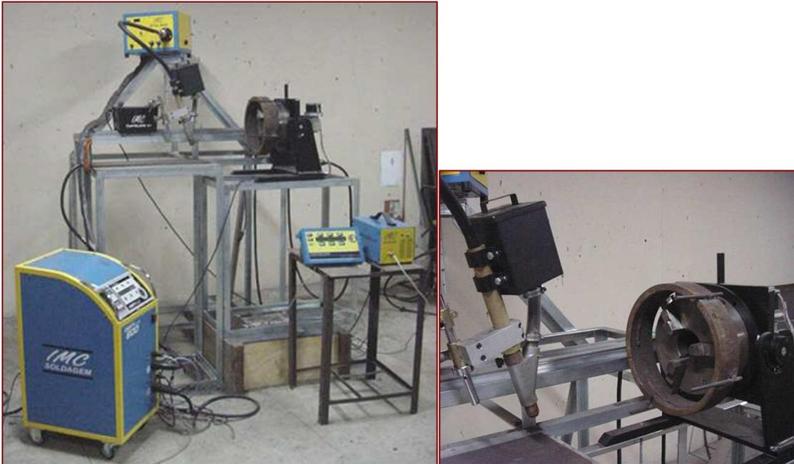
Figura 19 – Equipamento de soldagem por arco submerso.
