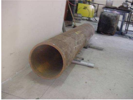
Figura 18 - Tubo de aço API 5L Gr B na condição como-recebida.
