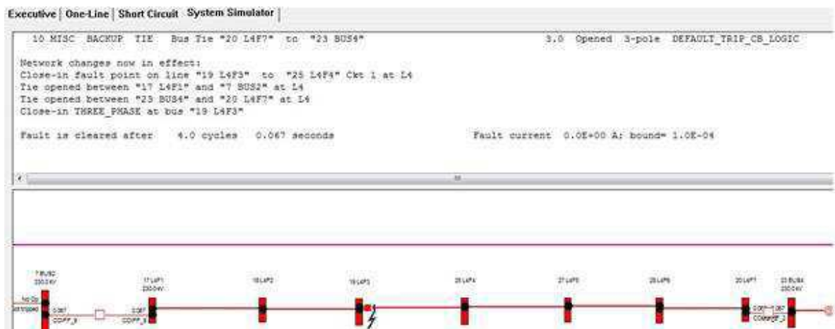
Figura 3.14. Abertura dos disjuntores da linha LT4 em condições de falta.
