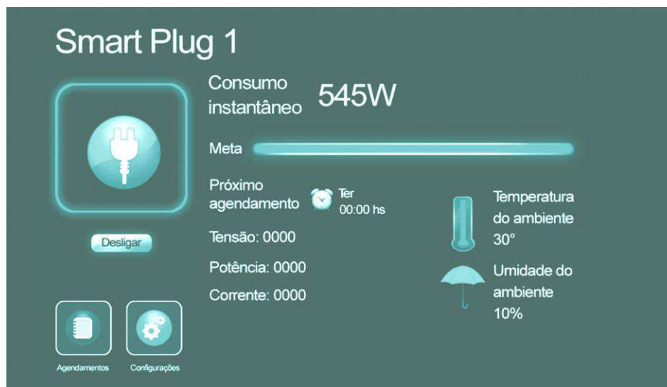
Figura 23 - Interface desenvolvida para celular e tablet para permitir a gestão remota das tomadas inteligentes do Programa Smart Grid Light [1].
