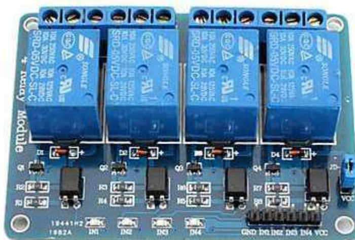
Figura 14: Módulo com 4 canais optoisolados.
