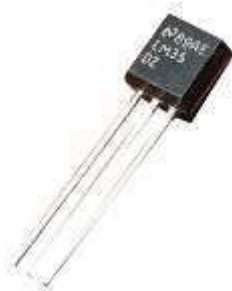
Figura 8: Fotografia do LM35, sensor de temperatura.
