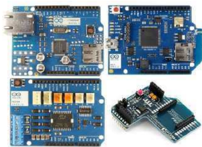
Figura 5: Shields Arduino. Ethernet , WiFi , motor e Xbee .
