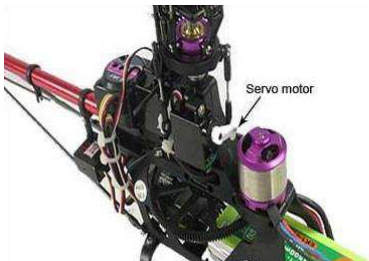
FIGURA 6: REPRESENTAÇÃO DO USO DO SERVO MOTOR NO ÂNGULO DE PITCH
