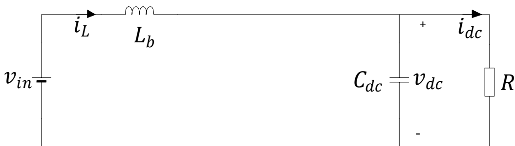
Figura 2.8: Circuito elétrico do boost equivalente para quando a chave estiver aberta
