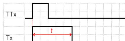
Figura 10: Funcionamento do temporizador no modo B
