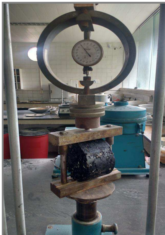
Figura 34 - Ensaio de Resistência à Tração por Compressão Diametral.
