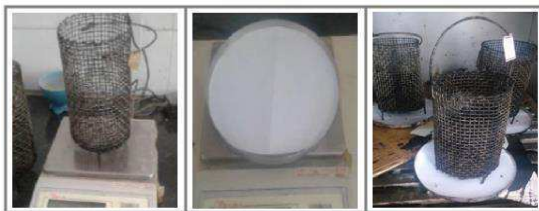
Figura 31 - Procedimentos de realização do ensaio de escorrimento.
