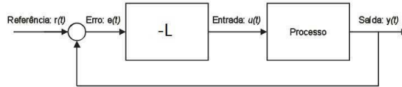
Figura 2.1: Diagrama de blocos do controlador obtido com a realimentação linear de estados
