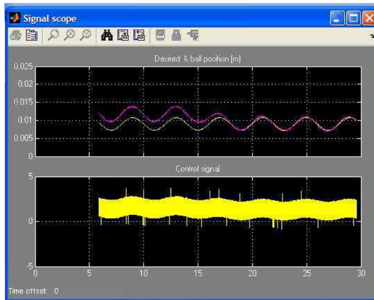
Figura 4.18: Sinal desejado e sinal adquirido durante a execução do Maglev_PID
