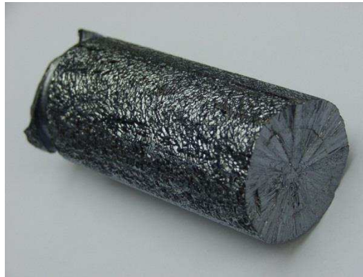
Figura 11. Cilindro de silício monocristalino. (Blue Sol Educacional, 2012)
