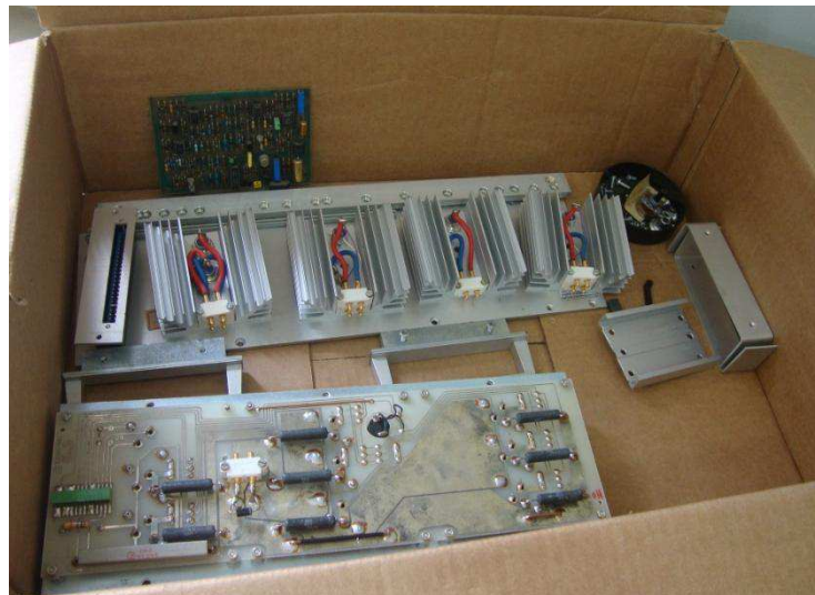
Figura 16 – Placa de transistores (abaixo), diodos e tiristores (montados em dissipadores).
