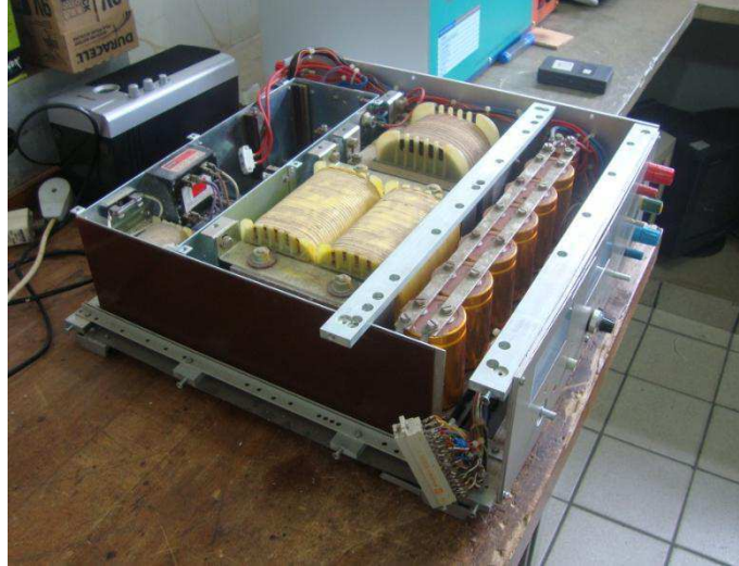
Figura 14 – Destaque do transformador, indutor e capacitor da fonte.
