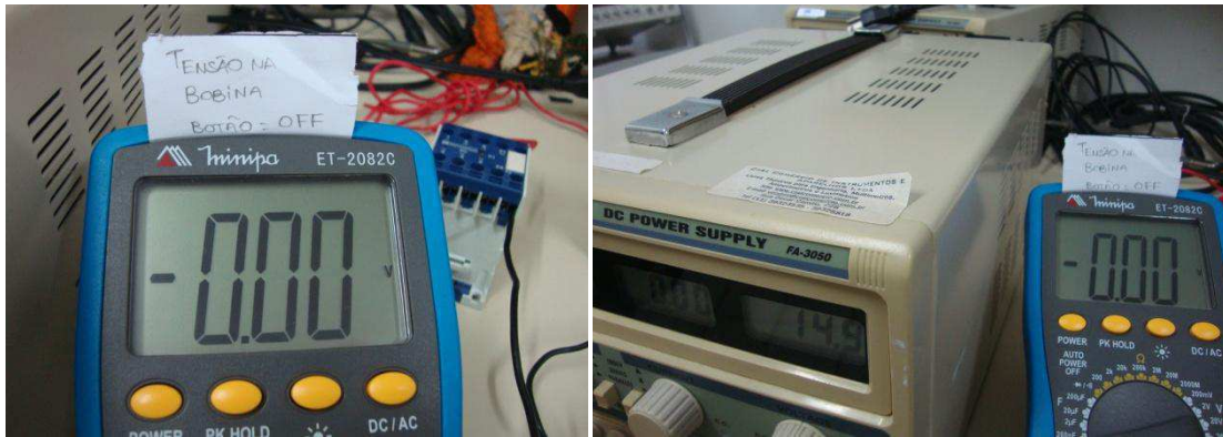
Figura 29 – Tensão na bobina com botão não acionado. (a) (b)
