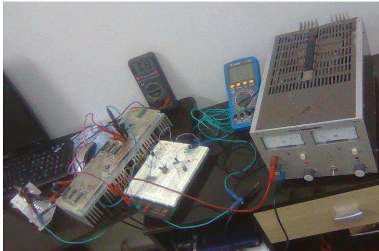
Figura 25 – Teste da placa de transistores e do regulador de tensão.
