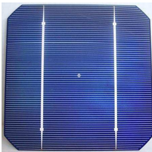
Figura 3.4. Célula fotovoltaica de silício monocristalino. [14]
