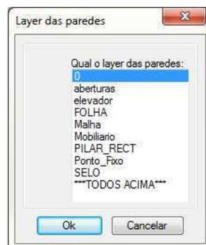
Figura 30. Escolha dos layers das paredes.
