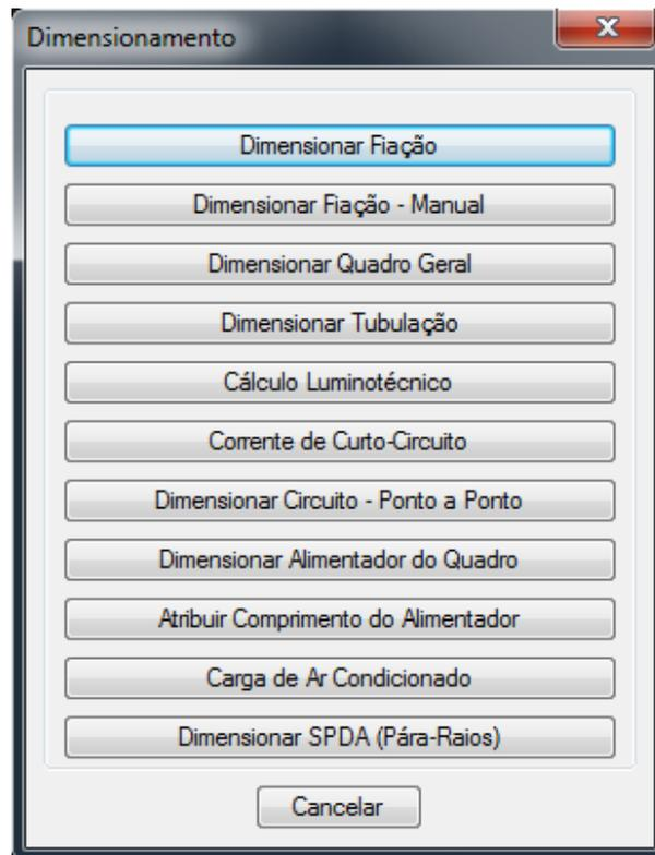
Figura 23. Menu da ferramenta *Dimensionamento*.
