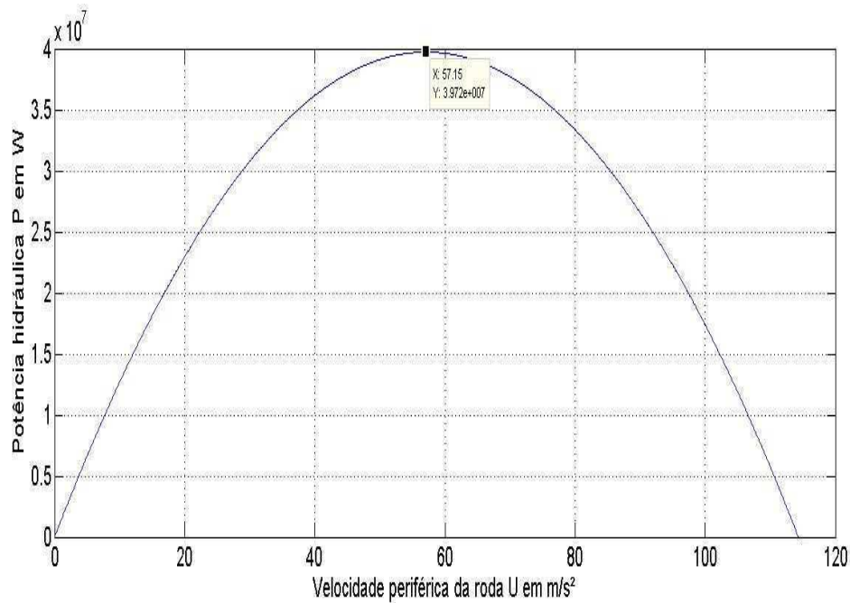
Figura 42 Gráfico da potência hidráulica em função da velocidade periférica da roda
