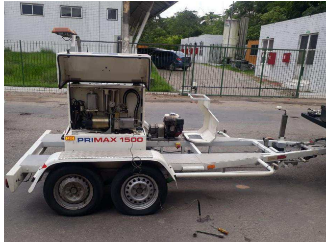
Figura 46 - Equipamento FWD PRIMAX 1500 utilizado nesta pesquisa
