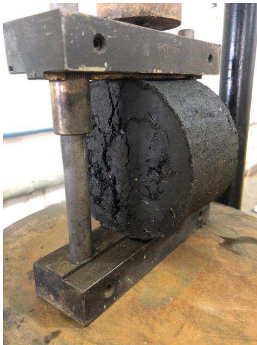
Figura 43 - Corpo de prova rompido após o ensaio de RT
