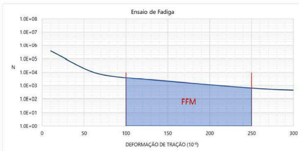
Figura 29 - Representação de curva de fadiga para cálculo do FFM
