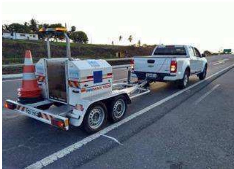
Figura 20 - Execução de ensaio FWD
