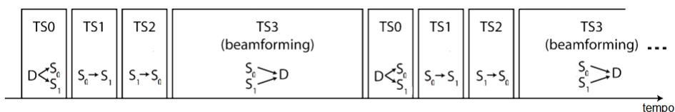
Figura 2.7: Sequência temporal do método *Time-Slotted Round-Trip*. Fonte: Adaptado de [18].
