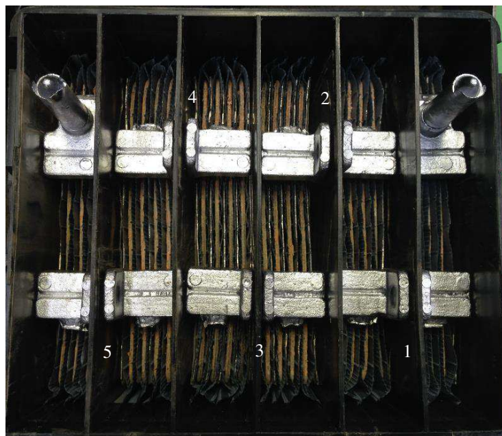
Figura 12: Elementos inseridos na caixa.
