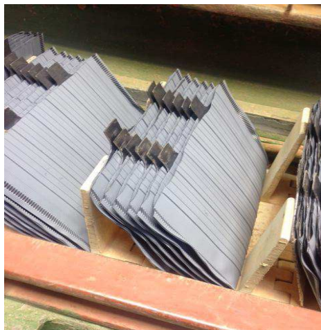
Figura 10: Imagem da placa negativa inserida no envelope e placa positiva fora.
