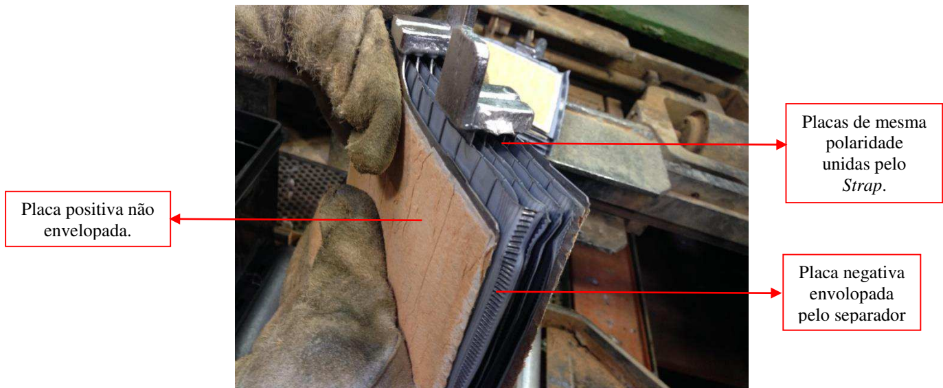
Figura 11: Elemento da bateria.
