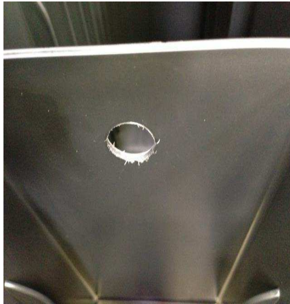
Figura 27: Imagem da rebarba na parede da caixa.
