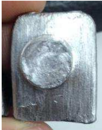
Figura 24: Ilustração da meia-lua na parte superior da solda.
