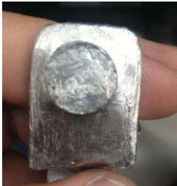
Figura 22: Ilustração de solda boa.
