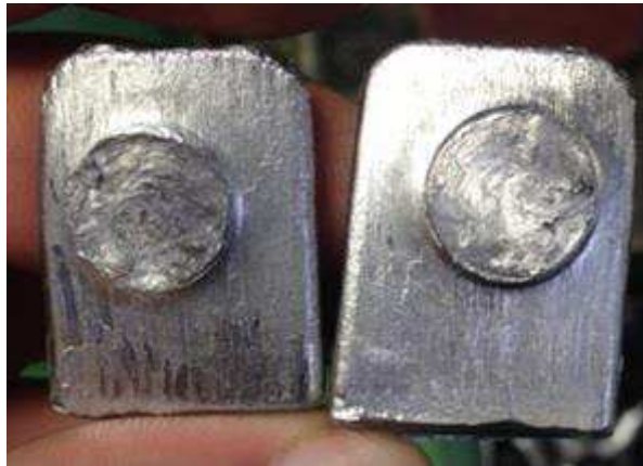
Figura 42: Imagem da solda abaixo limite de corrente.
