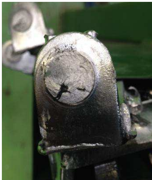
Figura 28: Ilustração da rebarba de plástico dentro da solda.
