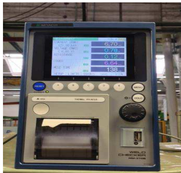
Figura 21: Imagem ilustrativa do Verificador de solda Miyachi MM-370B
