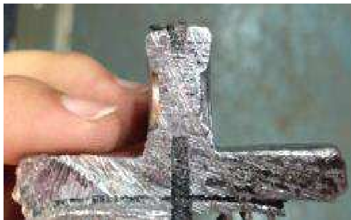
Figura 1: Imagem do corte transversal da solda intercell.
