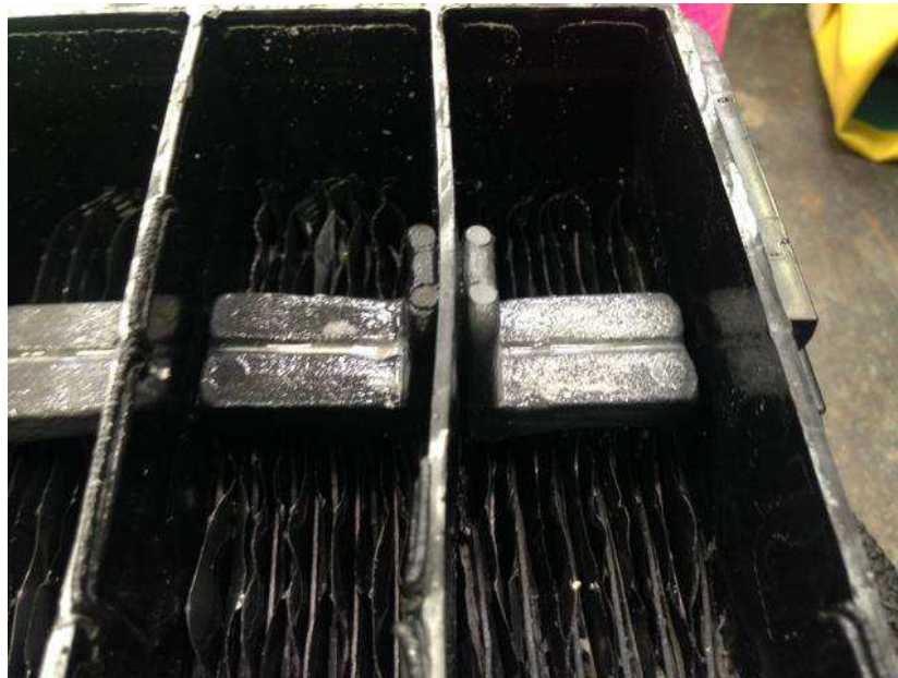
Figura 13: Imagem dos elementos conectados em série.
