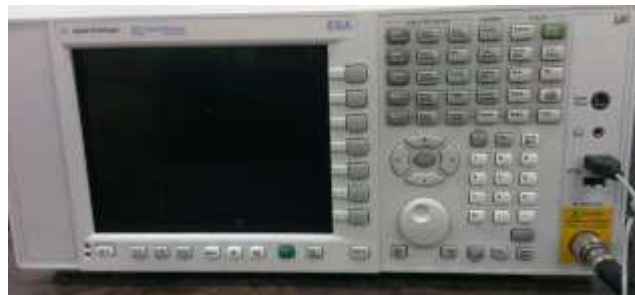
Figura 11: Analisador de espectros Agilent utilizado no trabalho.
