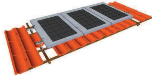
(b) Suporte para telhado para até três painéis solares.
